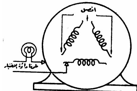
د - بعد تحديد الوجه الذي به ذلك التماس الأرضي يكون لدينا خطوة تحديد المجموعة أو الملف الذي به التماس بشكل أكثر دقة وتحديد ويتم ذلك بفصل المجموعات عن بعضها ويتم فحص كل مجموعة على حده ويتم الفصل على الشكل التالي
